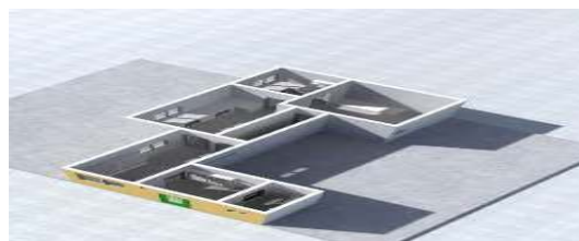
Photo 8. Absence d'issue de secours visible ou accessible.
